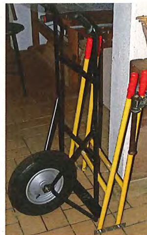
Links zwei Transporthilfen: Vorne eine Einradkarre und hinten ein Gestell, das man über einen verzurrten Bienenkasten stülpt und dann zu Zweit wegtragen kann. – Rechts: Mit dieser Karre mit Überschlagbügel rutschen auch im unebenen Gelände die Kästen nicht herunter.
