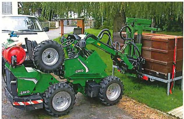
Hoflader sind sehr geländegängig. Mit spezieller Gabelvorrichtung lassen sich Bienenkästen auch seitab von Wegen aufstellen.
